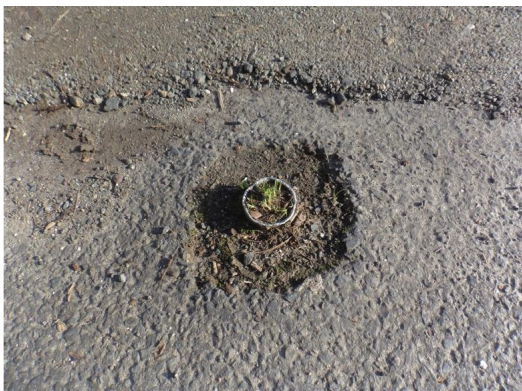
Tête du tube inclinométrique en février 2016 vers P.160 (source Rateau Ing.)
