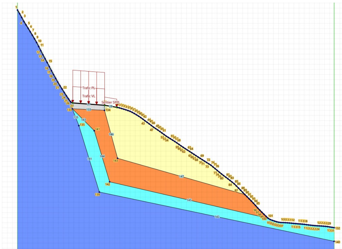
Coupe géotechnique interprétée au droit du profil P.470
